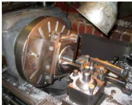
Svarvning av lager i svarvfixtur.
