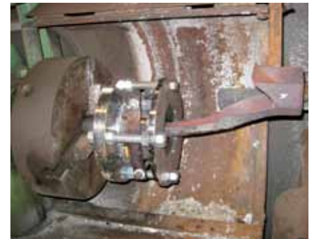
Lager med centrifugaljutningsfixtur i centrifugaljutningsmaskin.
