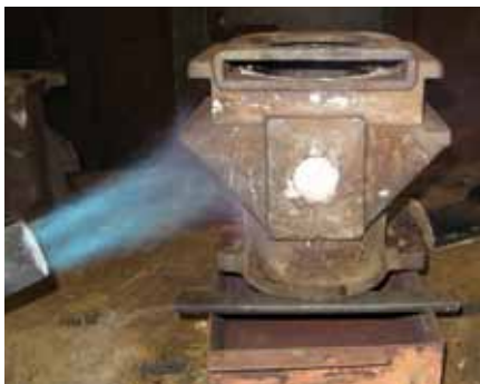
Ursmältning av gammal babbits med gasolbrännare.
