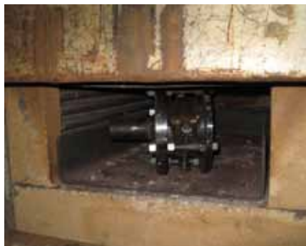
Förvärmning av lager med centrifugaljutningsfixtur i ugn.
