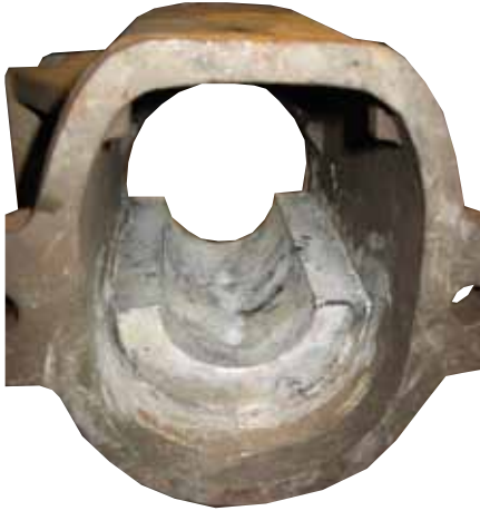
Vagnslager efter gjutning sedan kokillen demonterats.
